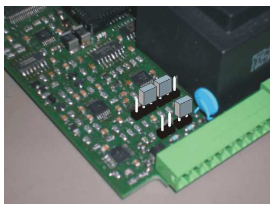
wejście A: napięciowe, wejście B: prądowe
