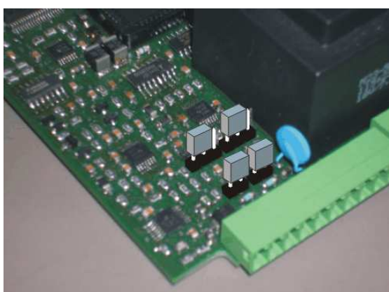
Ustawienie fabryczne wejście A: prądowe, wejście B: prądowe
