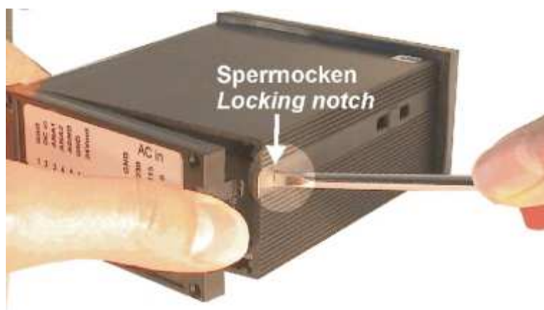
Usuń tylną część obudowy
