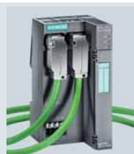
Interfejs IM 151-3 PN do PROFINET ze skrętką Cu
