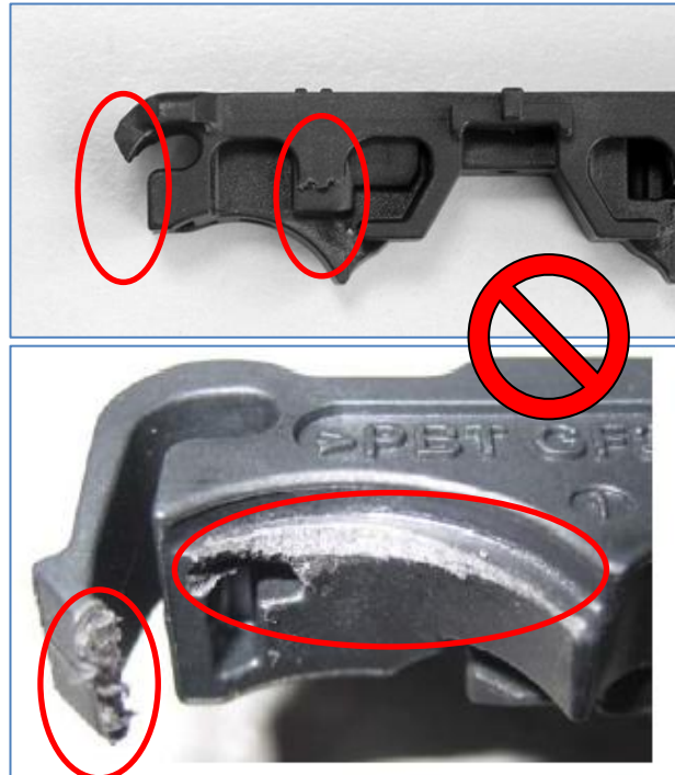
Image 8: two latching hooks are broken. Slider is not OK if one of the four latching hooks is missing or broken bzw. die Anlagefläche beschädigt ist.
