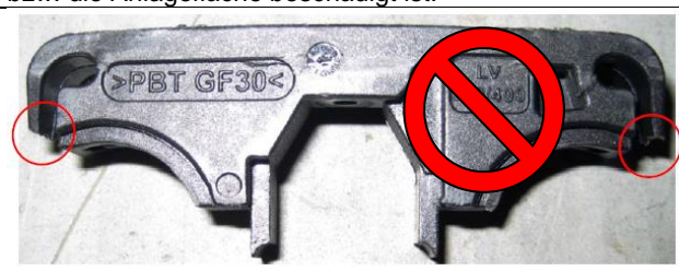
LV 320/400 S Schieber mit beschädigten Rasthaken
