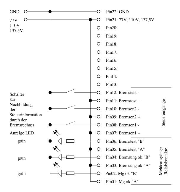
Das Testgerät benötigt externe Versorgungsspannung und stellt die für den Logikteil des ZL213 notwendige Versorgungsspannung bereit. Zusätzlich verfügt es über Schalter für die Anforderungen (Eingaben) und LED für die Anzeigen (Ausgaben). Das Testgerät wird über ein Kabel an X2 des ZL213 verbunden. Pin 1 des Steckers X2 siehe auch die Zeichnung des Gerätes. Der Stecker X2 ist verpolungssicher.
